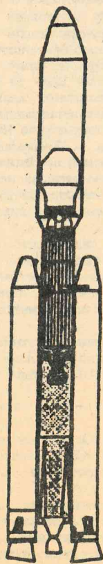
Ракета-носитель «Титан-4». Изображена модель 401 — с разгонным блоком «Центавр». Ракета модели 403, запущенная 2 августа, разгонного блока не имеет.
